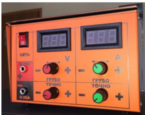
Прибор производит заряд аккумулятора/аккумуляторной батареи в автоматическом режиме, требуется лишь установить верхний порог напряжения и ток заряда, исходя из типа аккумуляторной батареи. На первом этапе прибор будет поддерживать установленный зарядный ток, а при достижении верхнего порога напряжения на аккумуляторной батарее прибор автоматически переходит в режим стабилизации напряжения, при этом зарядный ток по мере заряда постепенно снижается.
